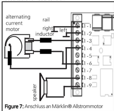
Figure 7: Anschluss an Märklin® Allstrommotor
